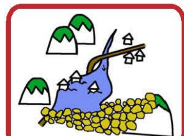
河川閉塞→決壊→土石流
