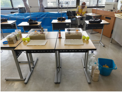
液状化実験装置（水槽の砂と水）
